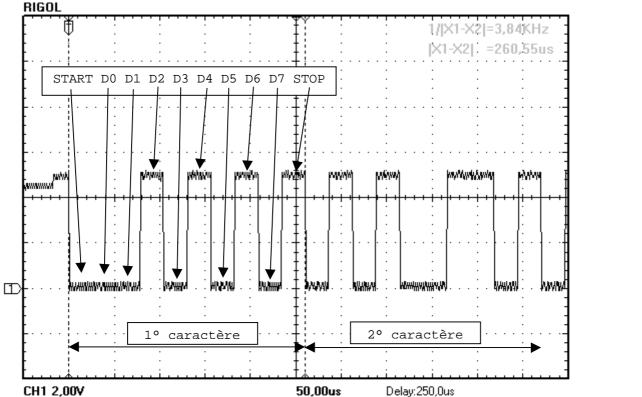
Pour identifier la trame série du premier caractère, on règle l'intervalle entre les curseurs de l'oscilloscope à la valeur nominale de la durée de la trame :  $10/38400 = 260 \mu S$ . Le curseur de gauche est alors placé au début du bit START qui est facile à identifier.
