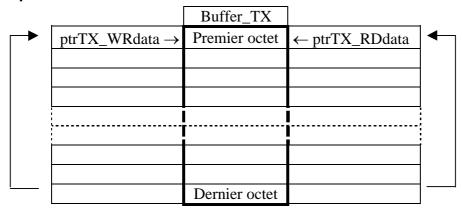
Le "**Buffer\_TXD**" est un bloc d'octets consécutifs en RAM du microcontroleur. Sa taille dépend de l'application (quelques octets à plusieurs koctets).
