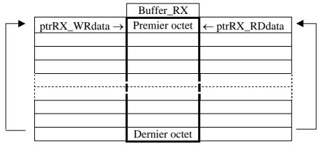
Le "**Buffer\_RXD**" est un bloc d'octets consécutifs en RAM du microcontroleur. Sa taille dépend de l'application (quelques octets à plusieurs koctets).
